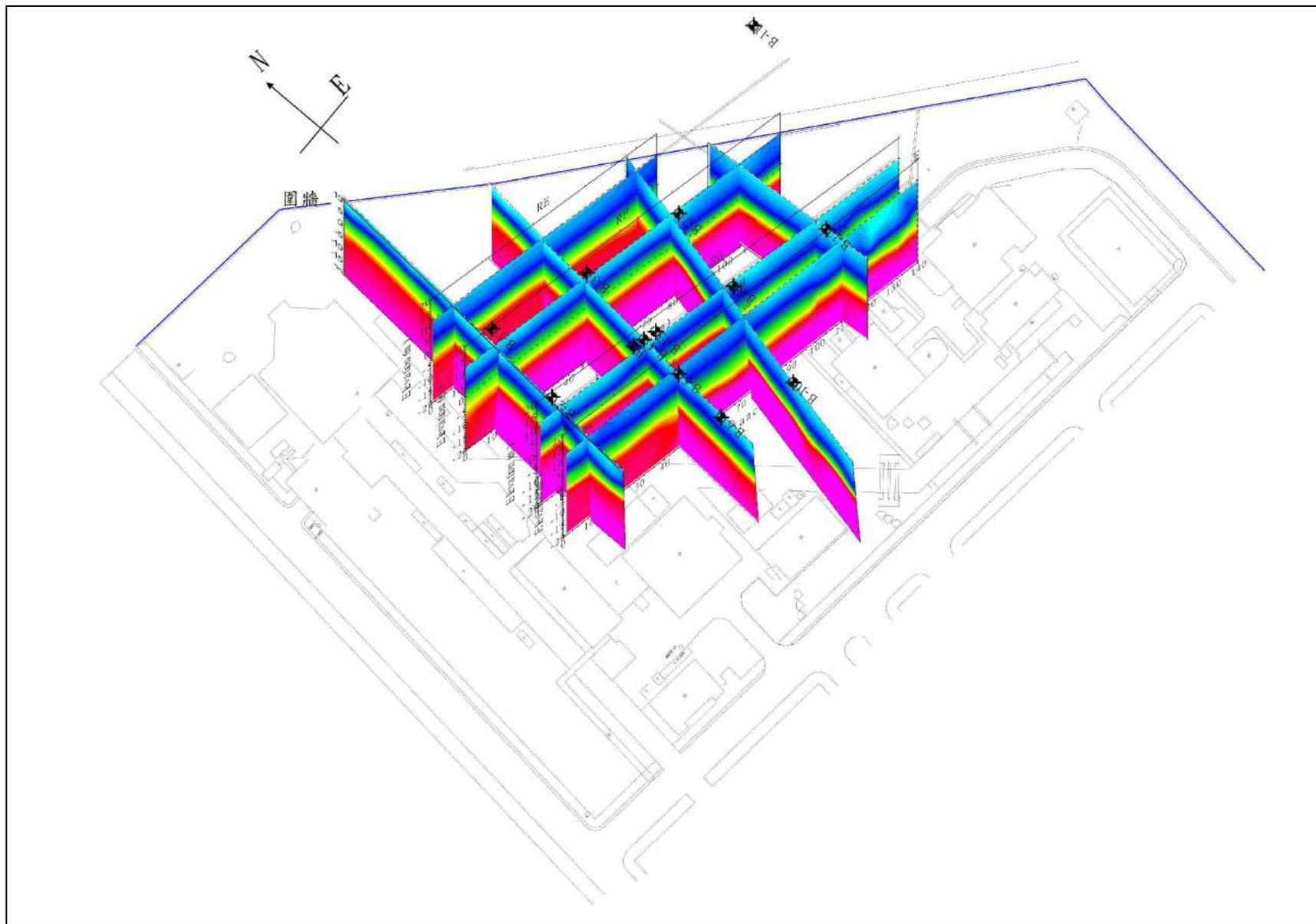
圖 3.4 折射震測各測線速度層柵狀立屏圖
