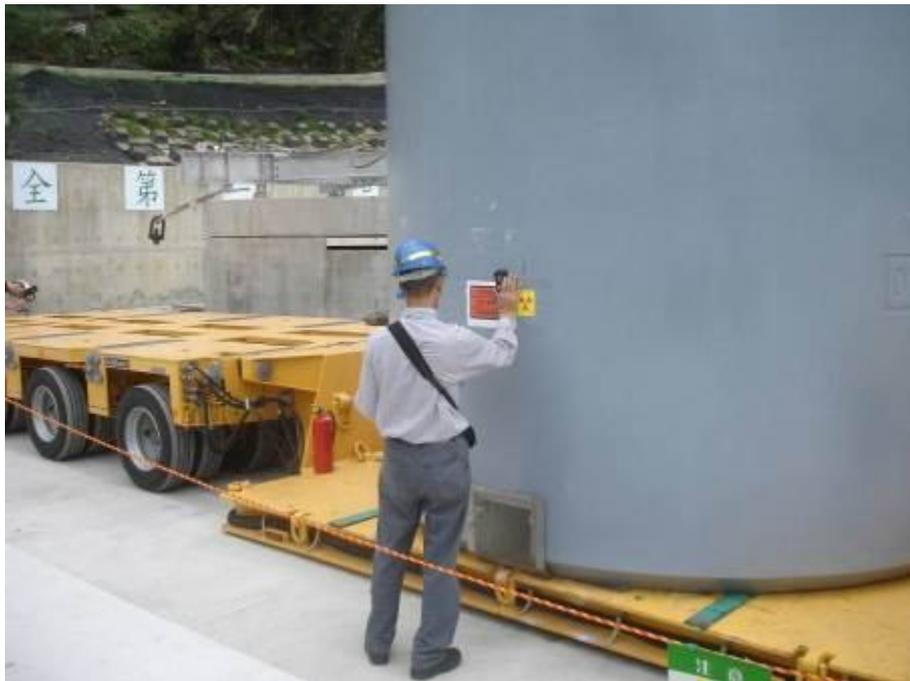
圖 3.2.62 混凝土護箱表面劑量率量測
