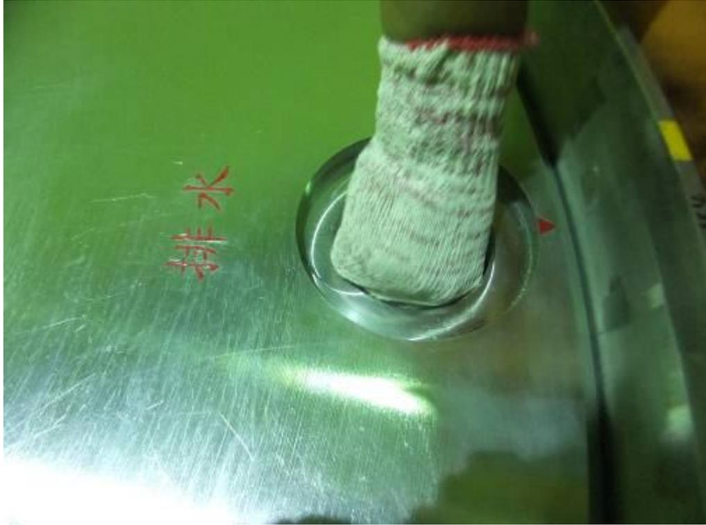
圖 3.2.7 密封鋼筒屏蔽上蓋與排水管組合測試
