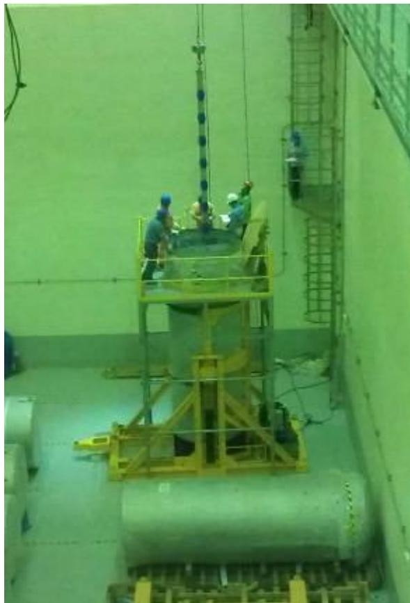
圖 3.2.10 密封鋼筒燃料方管阻力測試(1)
