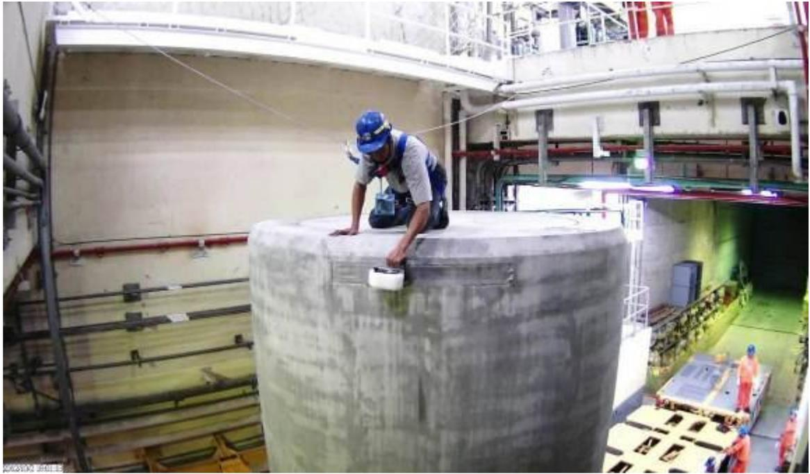
圖 3.2.37 中子劑量率量測
