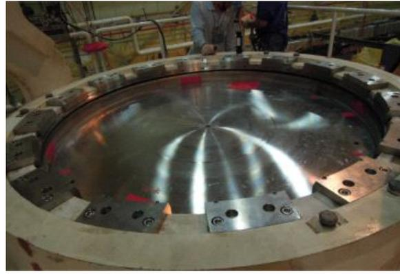
圖 3.3.3 傳送護箱頂部安裝上水密封機構前後
