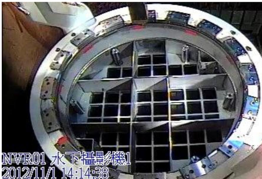
圖 3.3.5 傳送護箱定位後頂部照片
