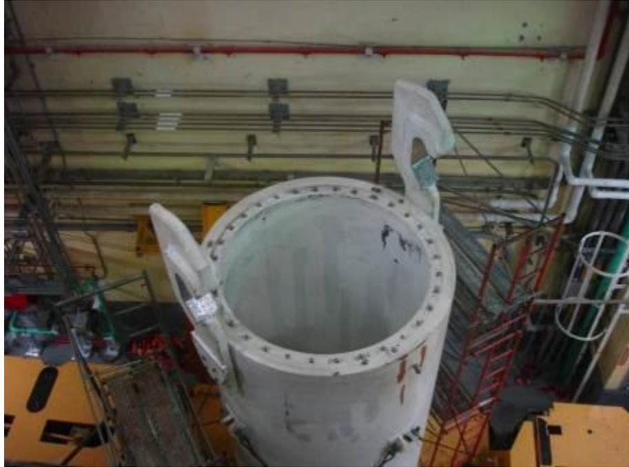
圖 3.2.5 J 型鉤安裝完成護箱頂部狀況
