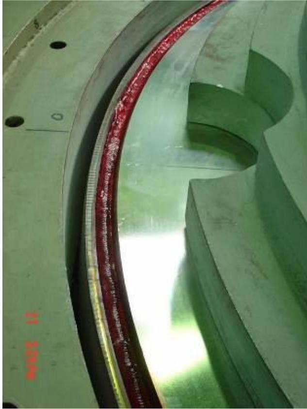
圖 3.1.9 結構上蓋液滲檢測-滲透
