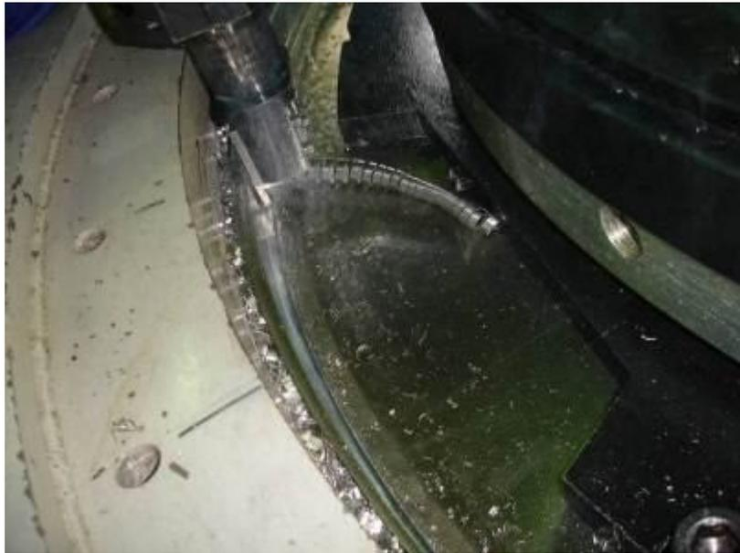
圖 3.1.21 切削中的屏蔽上蓋銲道
