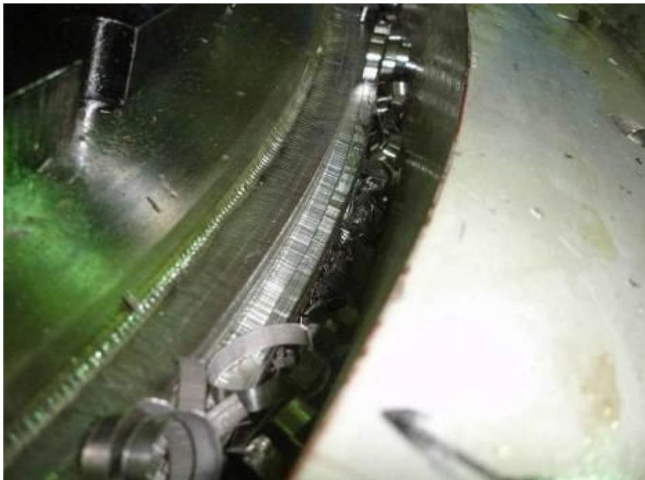
圖 3.1.14 執行移除切削後所產生之切屑
