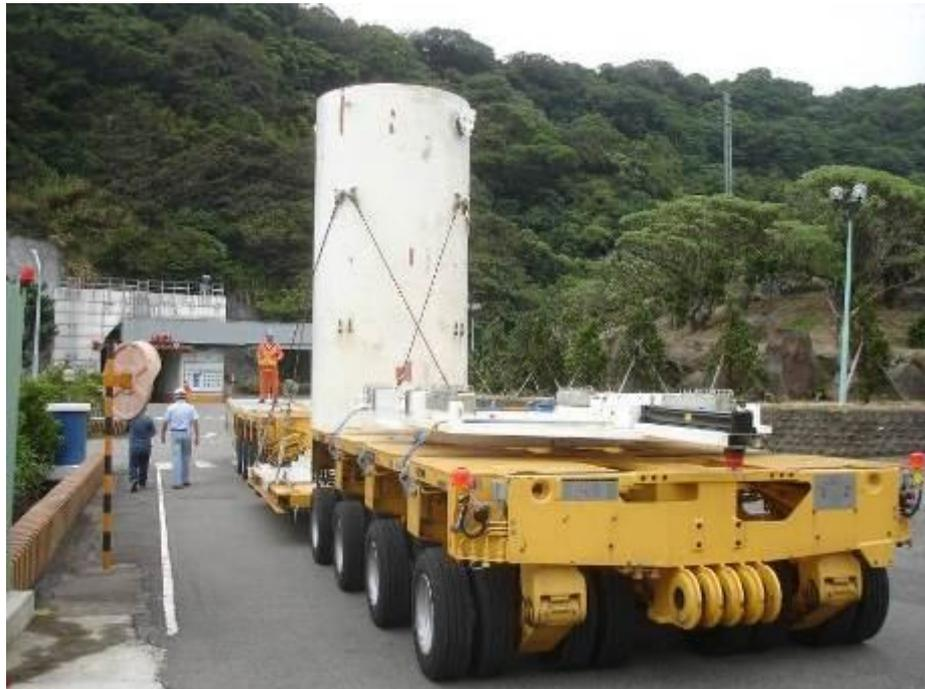
圖 3.2.4 傳送護箱運送往 1 號機反應器廠房
