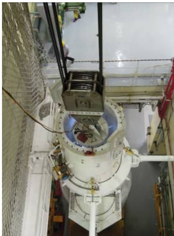
圖 17 可遙控脫鈎密封鋼筒吊具穿越傳送護箱內部
