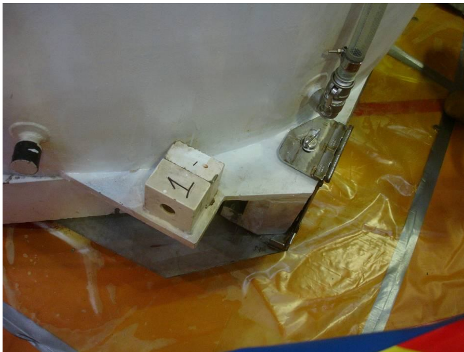
圖 43 傳送護箱底部防污板安裝完成貌
