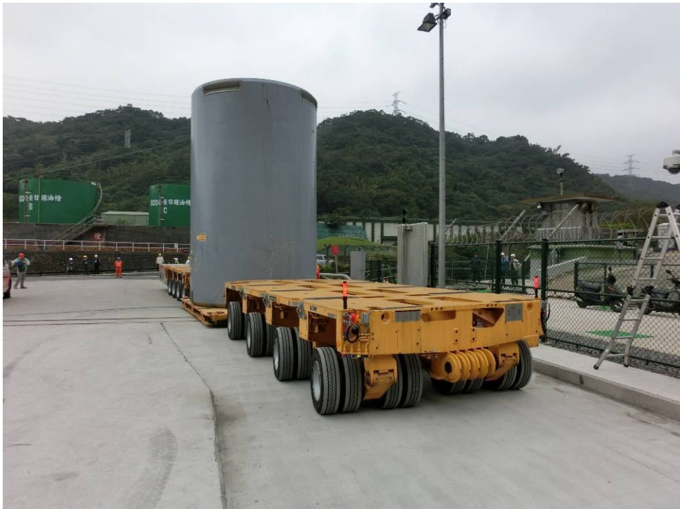
圖 6 多軸油壓板車駛離貯存場
