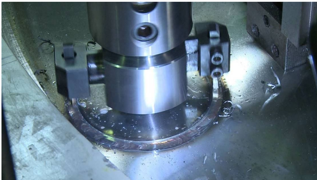
圖 29 移除封口蓋鐸道
