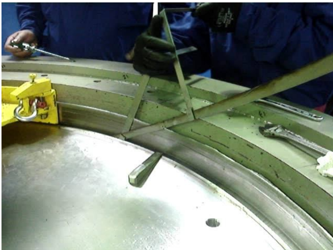
圖 41 屏蔽上蓋墊片取出作業
