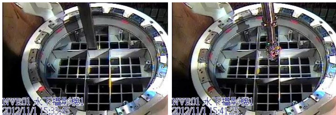
圖 48 於孔位 DC-4(左)與 DD-5 吊運假燃料之測試照片
