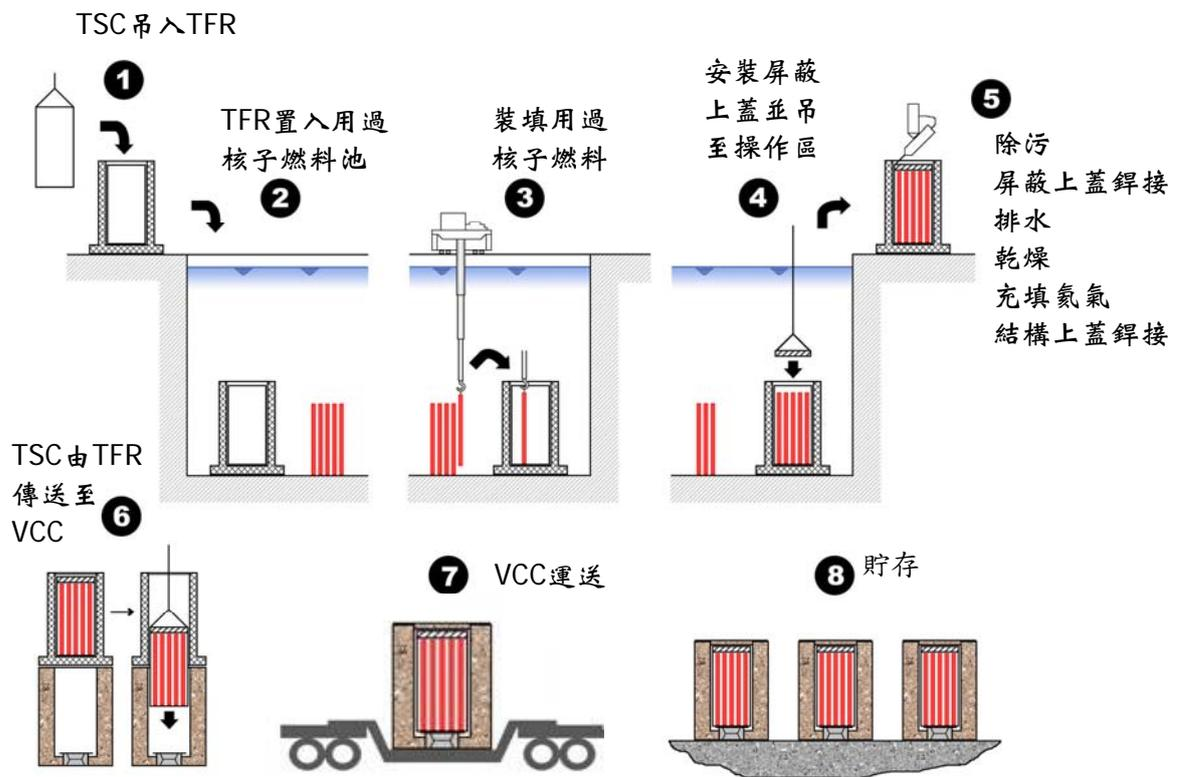
圖 4-2 安裝/吊運階段主要工作項目示意圖
