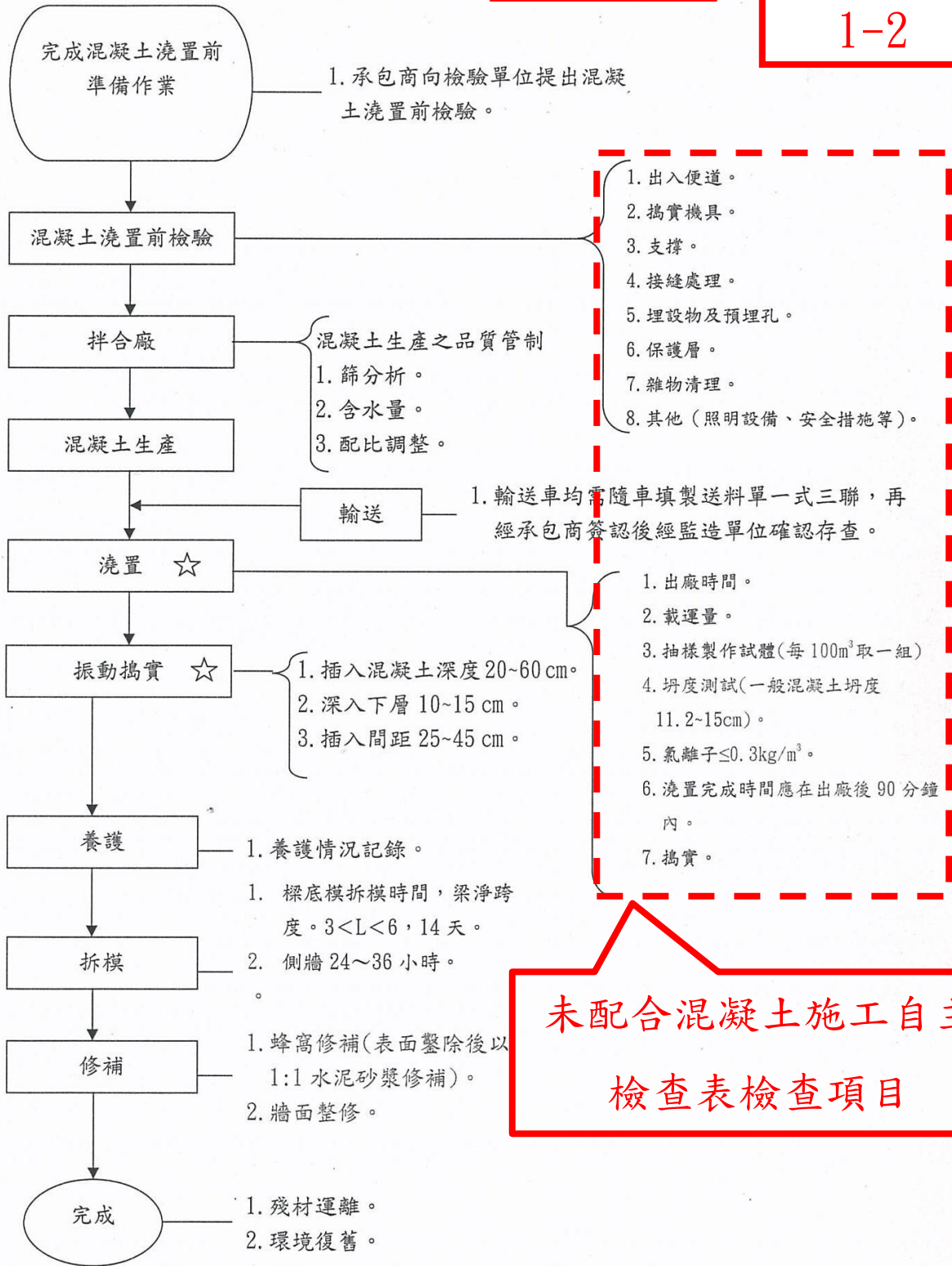
圖 a-5 混凝土施工流程圖
