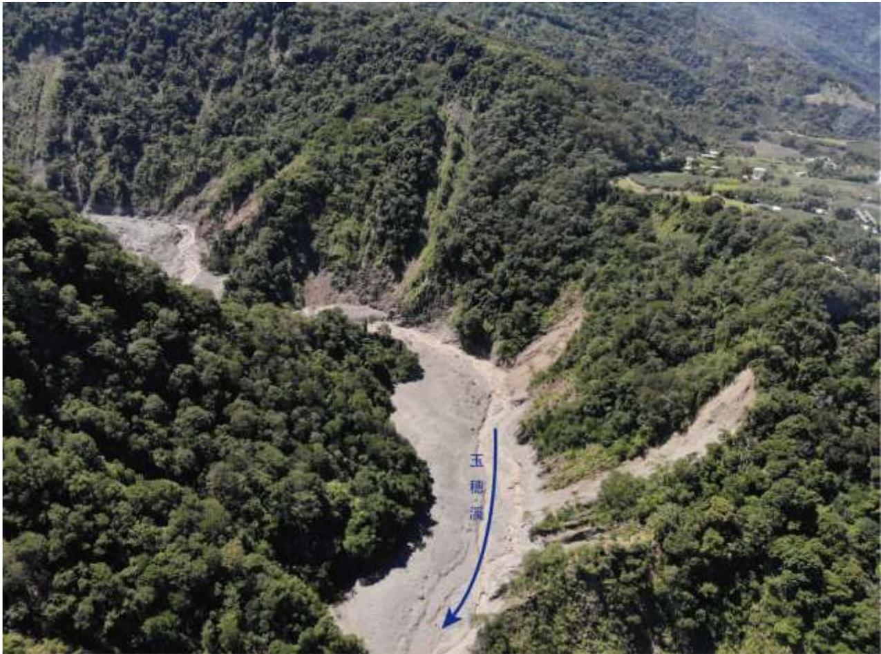
圖1 山崩與地滑地質敏感區(L0006高雄市)，110年0806豪雨事件造成高雄市桃源區山區新增山崩，圖中玉穗溪兩側山壁有新生崩塌。
