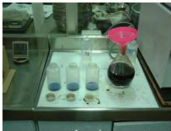
a. 瀝青甲苯溶液倒入蒸餾瓶
