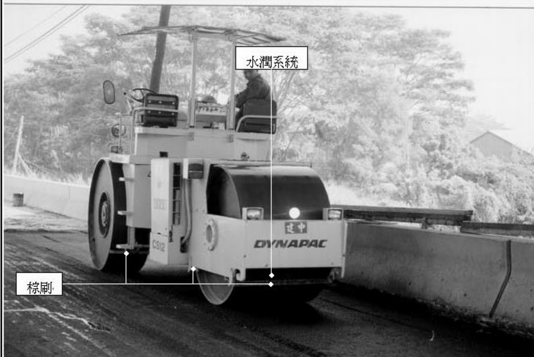
照片 6.8 二軸三輪壓路機(前輪及後輪尺寸相同)
