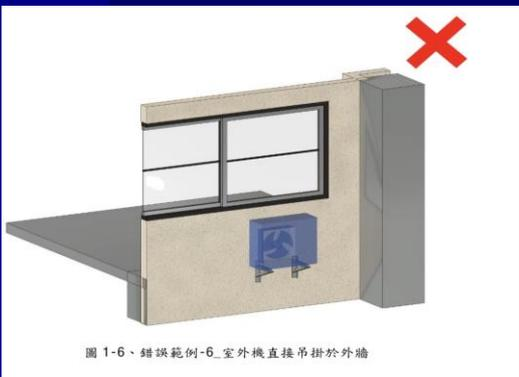
圖 1-6、錯誤範例-6\_室外機直接吊掛於外牆
