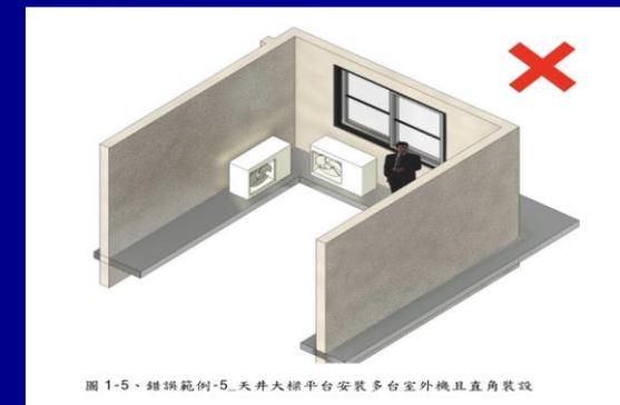
圖 1-5、錯誤範例-5\_天井大樑平台安裝多台室外機且直角裝設
