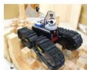
瓦礫上探索用クローラ型レスキューロボット "KOHGA2" (電気通信大学 松野文俊)
