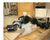
多連結クローラ型ロボット "KOHGA" (電気通信大学 松野文俊)
