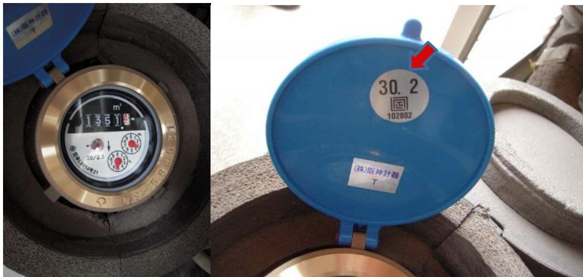
圖 1、日本水量計之檢定合格印證標識。(a)水量計；(b)水量計自行檢定合格印證，箭頭標示處表示檢定合格有效期至平成 30 年 2 月。
