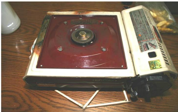
照片 18：將卡式爐反過來使用的毀損情況。
