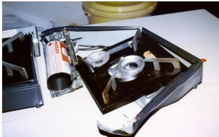
照片 20：卡式瓦斯爐的毀損情形。
