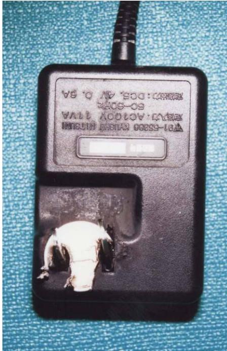
照片 10：起火原因為硬幣造成異電極直接接觸產生短路現象。
