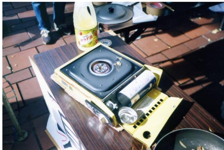
照片 19: 卡式瓦斯爐反過來使用的毀損情
