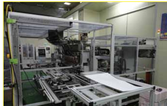
● 得獎標的：FULL HDTV 級 LCM 高密度基板黏合設備關鍵技術
