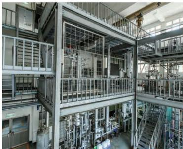
成過程中需用到的有機溶劑或原料單體等，皆必須經由分離純化程序提煉而成，此時，分離塔器的技術良窳，即成為分離純化效率以及耗能高低與否的決定性因素。
