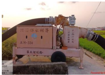
大型移動式抽水機
