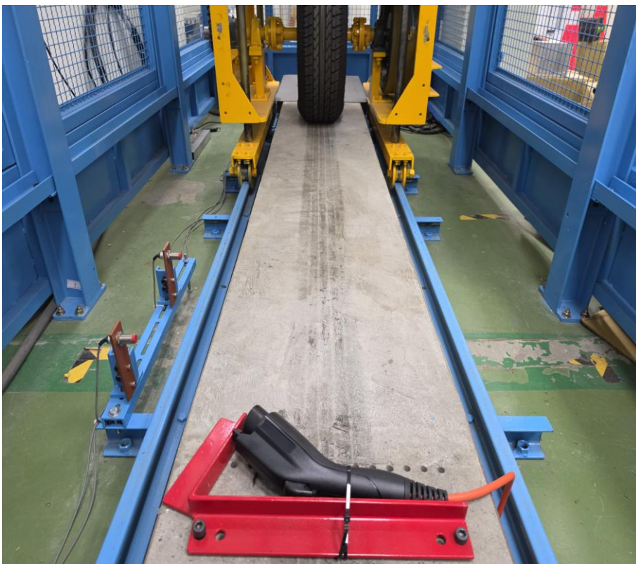
水泥鋪裝路面驅動車輪，模擬充電槍線遭車輛動態輾壓
