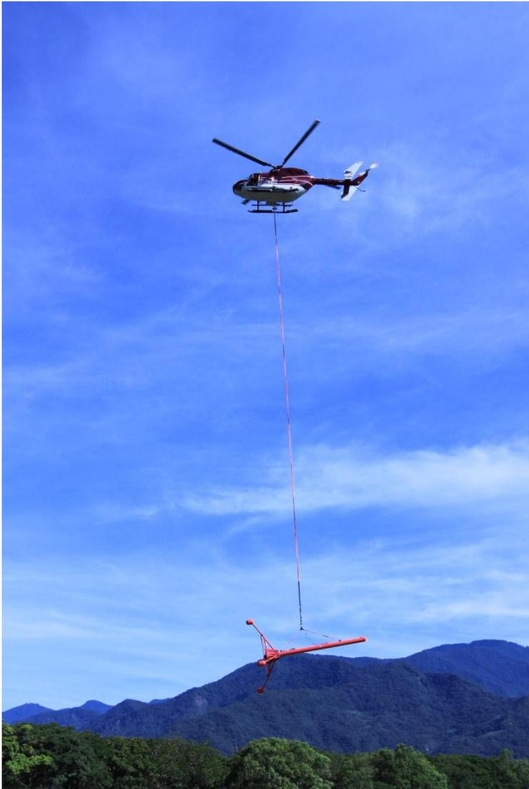
直升機吊掛三軸磁力拖鳥進行探測
