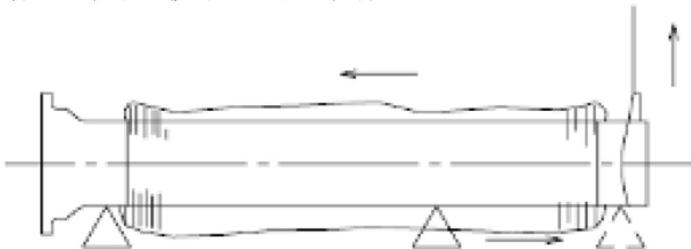
(5)PE 套膜平順包覆於管上，盡量使 PE 套膜緊貼管身，多餘部分應摺疊於管頂每隔約 1m 以膠帶固定；另，PE 套膜需由管兩端各延伸約 50cm 以利機械接頭處包覆。
