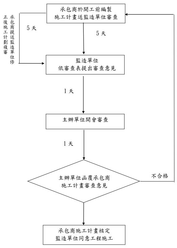
圖 4-1 施工計畫審查作業程序流程圖
