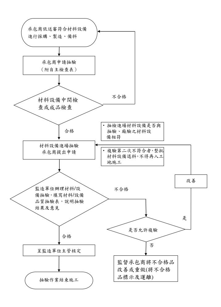
圖 5-2 材料/設備抽驗作業流程圖
