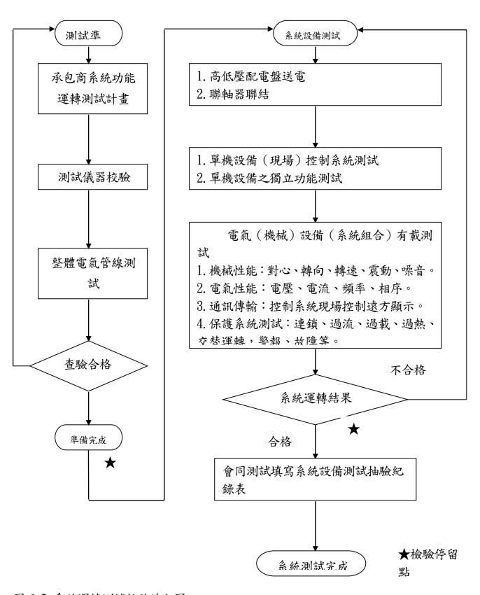
圖 6-2 系統運轉測試抽驗流程圖
