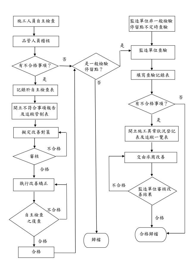
圖 7-1 施工抽查作業流程圖
