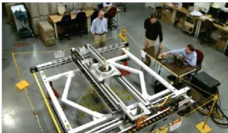
圖 3.3.1-4 IAEA 的貯存中用過核子燃料之查驗設備
