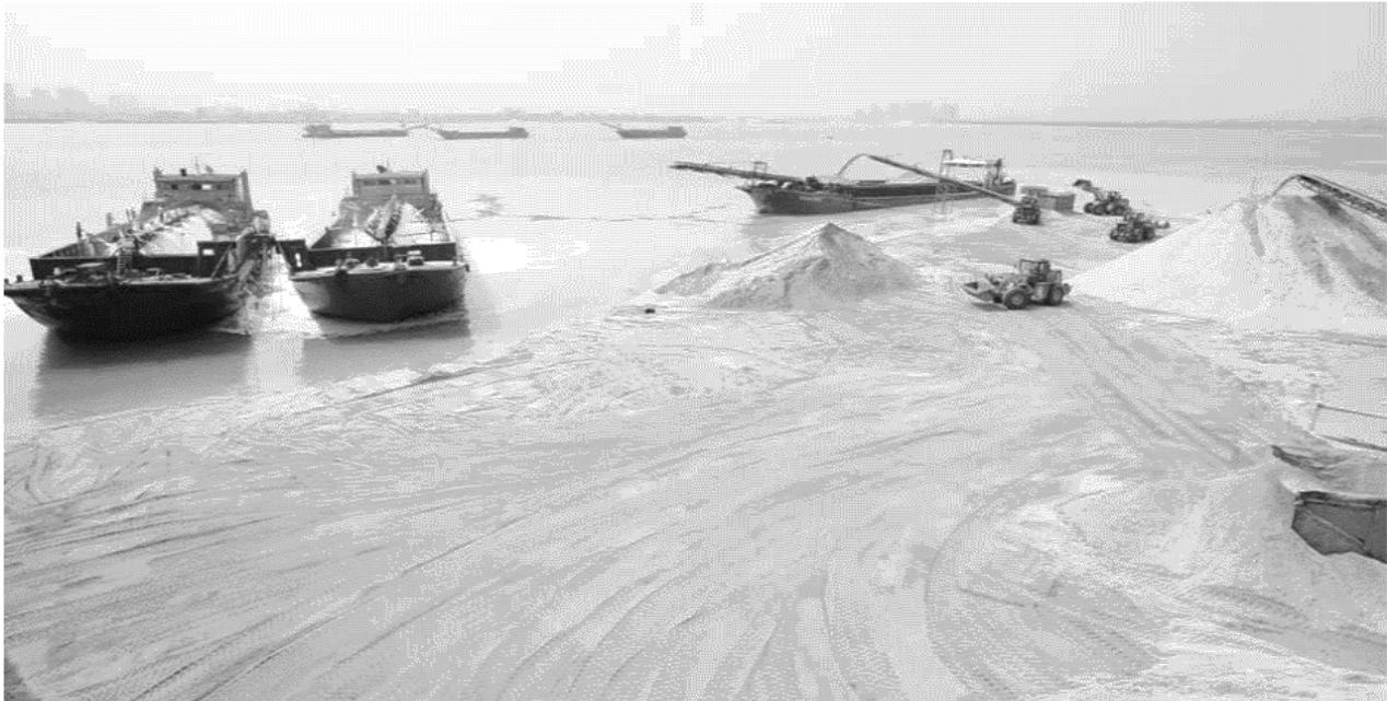
在金門海域抽到的海砂，經由水運和陸運運往廈門同安區的洗砂廠清洗。左方大型卸砂機器隆隆運轉，經卸砂和洗砂後，海砂區分為可用砂或廢棄物。一旁的怪手，則忙碌地把可用砂送上運砂船。
