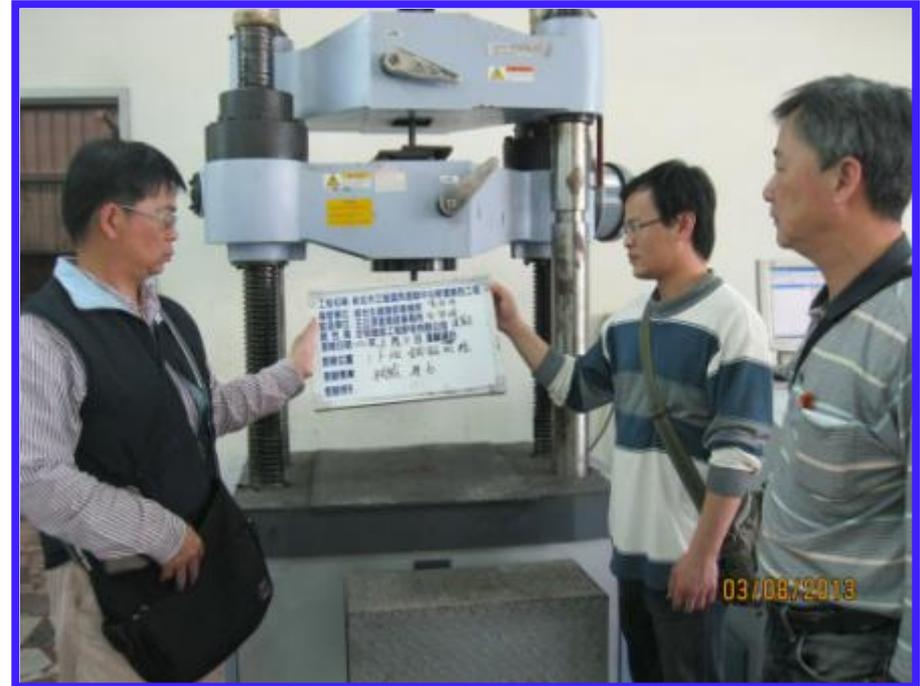
鋼筋取樣試驗
