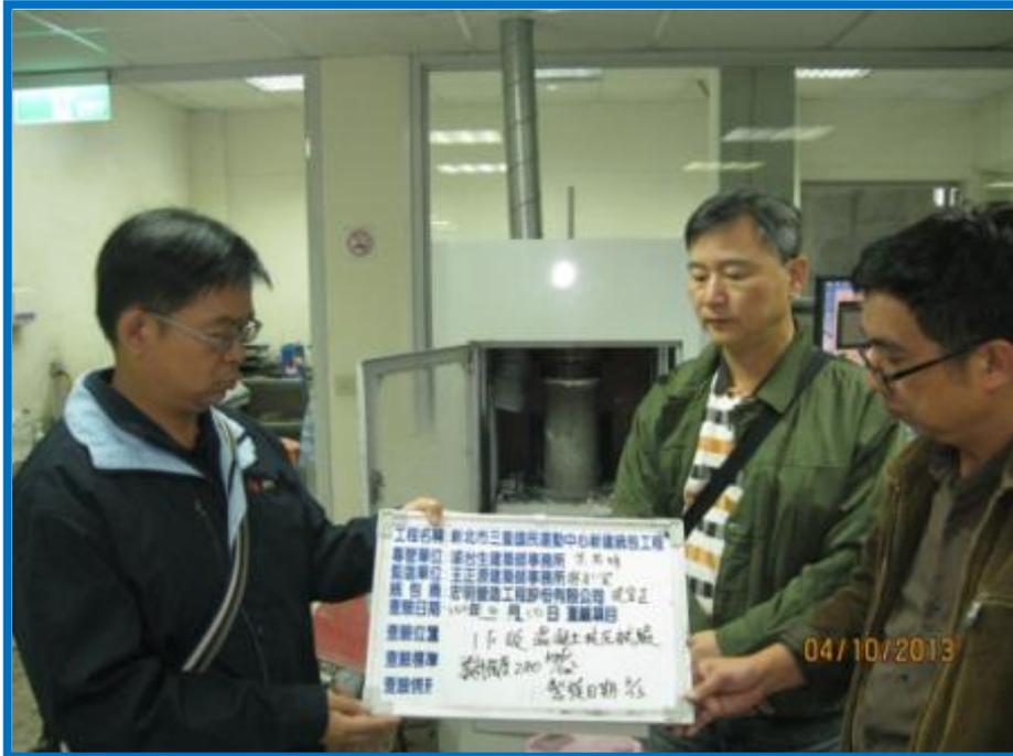
混凝土抗壓試驗
