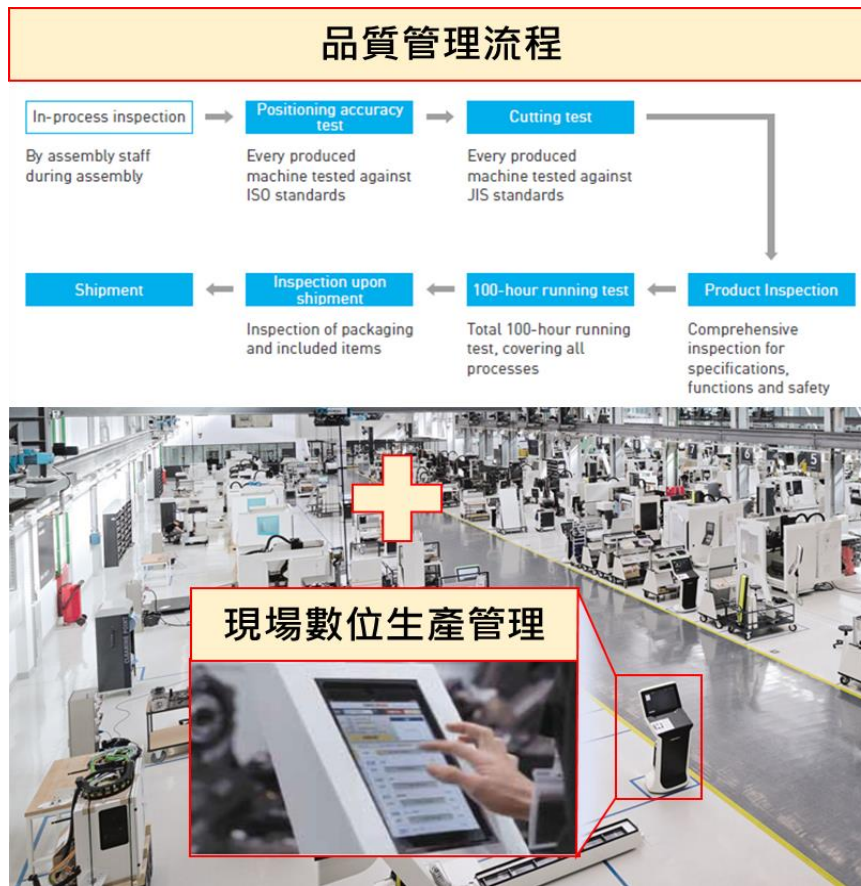
圖 6、全球工具機大廠 DMG Mori 數位化生產管理流程
