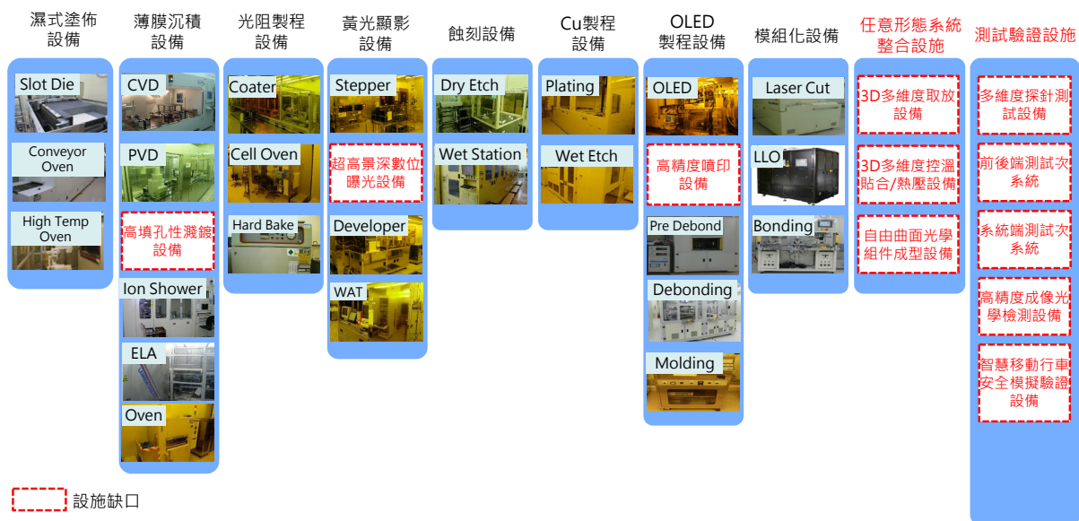
圖 9、任意形態顯示、感測與先進封裝整合之製造驗證之產業缺口示意圖 (法人整理)
