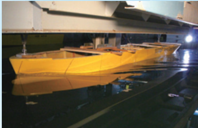
● 船舶中心與臺灣大學合作，進行節能船型10,000噸雜貨船之船模試驗
