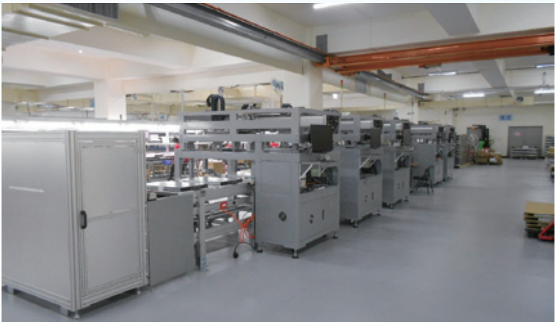
● 協助大訊發展具視覺定位技術之智動化鎖固系統，進行伺服器組裝自動化，從圖中可見生產效率的提升
