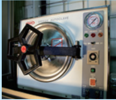
● 罐內漆也要通過所有食品檢測最重要的「滅菌」程序，將試片放進模擬液裡，送進高溫蒸煮設備，藉此測試漆膜是否會脫落
