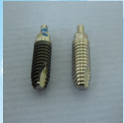
● 雷射牙根（左）有優良親水性、生物相容性及骨整合效果，圖右為一般牙根
