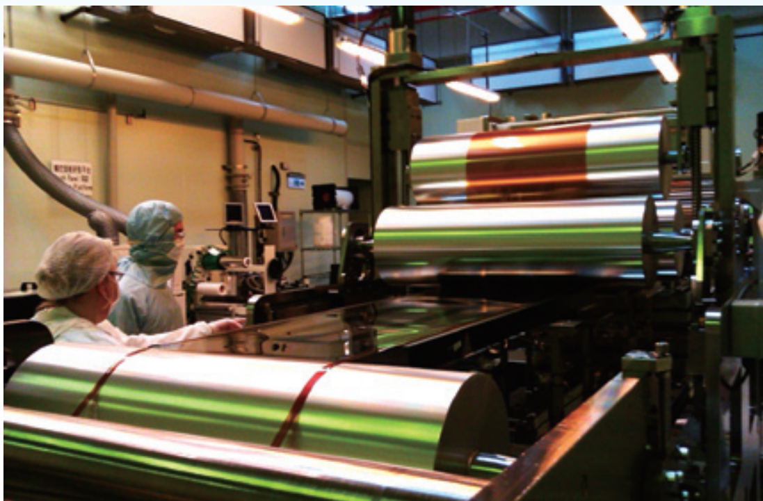
● R2R細線化設備為7合1機台，以一個印刷步驟即可製作出觸控面板薄膜
