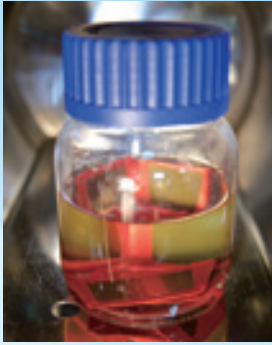
● 罐內漆也要通過所有食品檢測最重要的「滅菌」程序，將試片放進模擬液裡，送進高溫蒸煮設備，藉此測試漆膜是否會脫落
