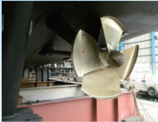
● 宏昇螺旋槳公司為中信造船廠所製造的低速船用端板螺槳，可提高推進效率
