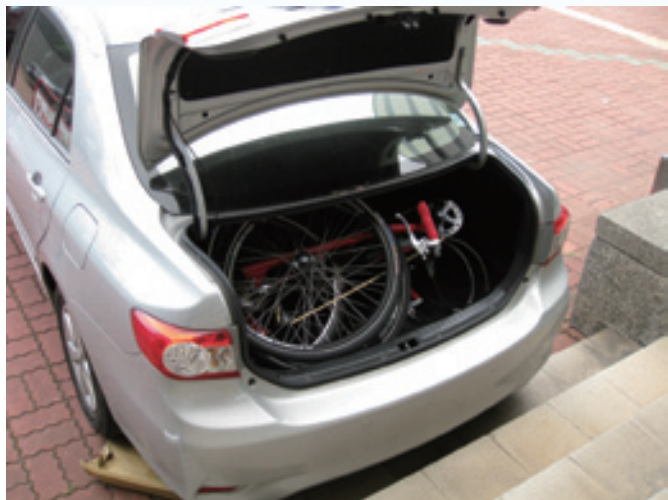
● 電輔式手搖車拆解後可放置於小轎車行李箱
