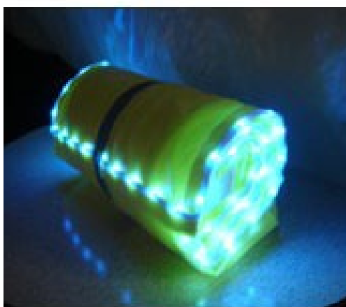
◀ LED 單車夾克捲曲收納後，可懸掛於自行車後座作為警示照明用。
