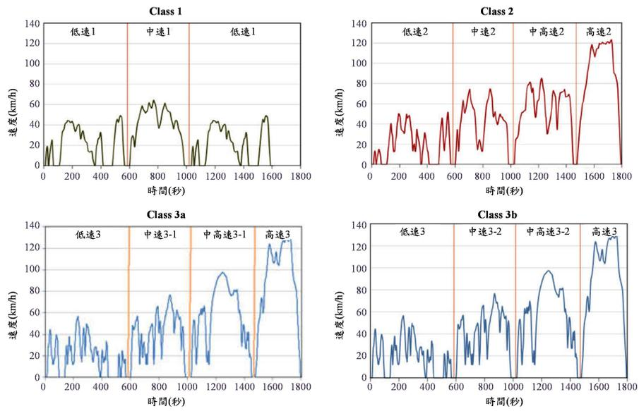
圖四、歐盟測試程序(WLTC 行車型態)
