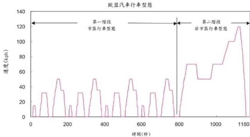
圖三、歐盟測試程序(NEDC 行車型態)
