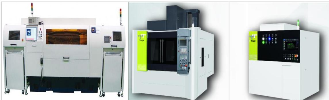
註：左為 PCB 雷射鑽孔機、中為噴粉式積層製造複合加工設備、右為金屬粉床式積層製造設備。
